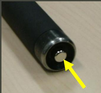
Ce dispositif permet le verrouillage des cylindres lorsque celui-ci est à la position ouverte ou permet d'enclencher la fermeture manuelle du bâton en poussant les cylindres (parties rétractables) à l'intérieur de la poignée
